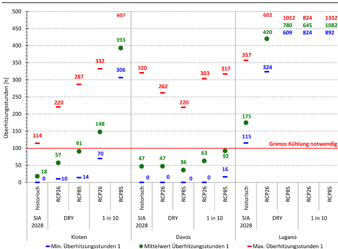
Abbildung 24: Überhitzungsstunden 1 (Grenzkurve Abbildung 21 ) im Wohngebäude während der Nutzungszeit von 3111 h (Periode: 16.4. – 15.10.)
