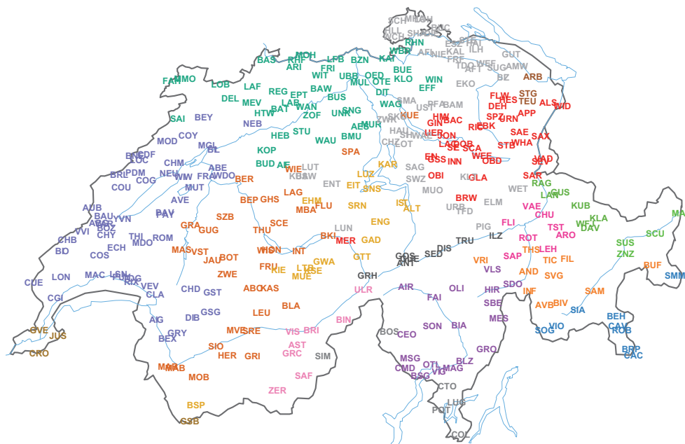
Abbildung 7: Gruppierung der 327 Standorte (nationale Abkürzung) mit homogenen Niederschlagsmessungen in 18 Cluster (verschiedene Farben). Die ausgewertete Grösse ist Gesamtniederschlag für das hydrologische Jahr (1.10.-30.9) im Zeitraum von 1962 bis 2008.
