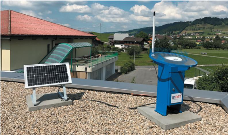
Abbildung 1: Automatischer Hagelsensor mit Solarmodul. Quelle: inNET Monitoring AG
