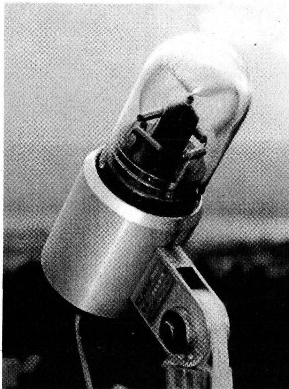
Abbildung 2.3: Sonnenscheindetektor Haenni Solar 111. Abgebildet ist das Gerät der ANETZ-Station Zürich, SMA.
